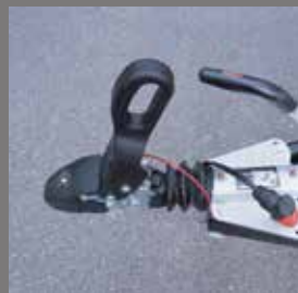
Sicherheitskupplung mit Spurstabilisierung
