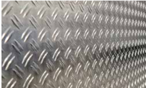
Bodenplatte mit Aluriffelblech belegt
