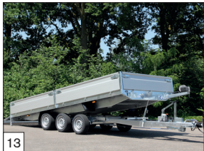
Option: Die Modellen in einer Größe von 505 x 200 und 505 x 220 cm sind auch als 3-Achser lieferbar und wenn Alu-Bordwände dann inkl. herausnehmbaren Mittelrungen.
