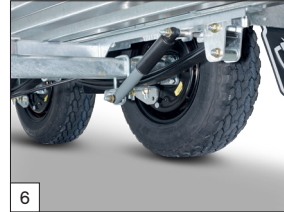
Option: Parabelfederung inkl. Stoßdämpfer (das Modell in 405 cm ist nicht lieferbar mit Parabelfederung).
