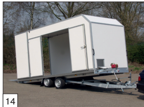
Option: Verschiedene Koffer Aufbauten sind möglich; z.B. Seitentür(e), verkaufsklappe(n), Schiebe- oder Aufroll-Rolladen.
