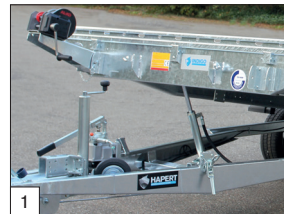
Serienausstattung: einer doppelt wirkenden Hydraulik-Pumpe, eine 3,5to-Auflaueinrichtung und eine feste Combi Protect Rail (80mm hoch) montiert.
