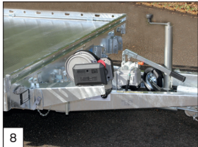
Serienausstattung: eine verstellbare Winde mit Halterung montiert an der Vorderseite.
