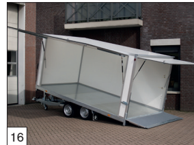
Option: Standard beim Koffer-Aufbau: Heckklappe ca. 100 cm hoch (nach unten schwenkend) und obere Klappe schwenkend nach oben.
