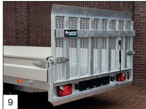
Serienausstattung: einer durchgehende Auffahrklappe 1000mm hoch inkl. Gasdruckfeder und robuste Verschlüsse.
