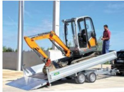
hydraulische 2 Seitenkipfung und nach hinten kippbar zum beladen DUO der Kipper und Maschinentransporter mit E Hydraulik und Fernbedienung Notpumpe Pumpless, Wartungsstütze
