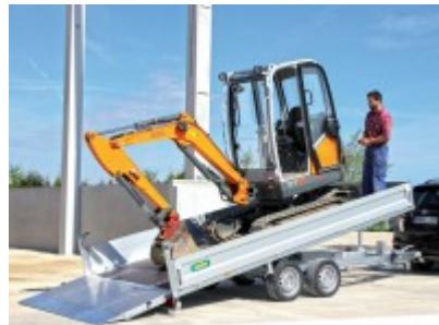
hydraulische 2 Seitenkipfung und nach hinten kippbar zum beladen DUO der Kipper und
