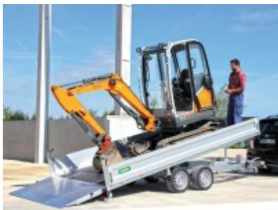
Bordwände 350 mm + Gitteraufsatz 600 mm 3 seitig hydraulische 2 Seitenkippung und nach hinten kippbar zum beladen DUO der Kipper und Maschinentransporter mit E Hydraulik und Fernbedienung Notpumpe Pumpless, Wartungsstütze
