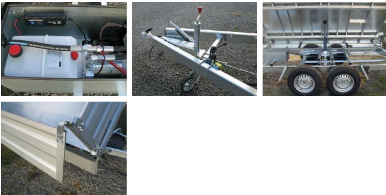
Sondermodell Plus 55 incl. 550 mm Unsinn Profil Alubordwandaufsatzz ( zzgl 82kg Gewicht bei Nutzlast beachten) **Hydraulik:** E Hydraulik mit Batterie und Ladegerät, Notpumpe Pumpless für Akkuschrauber Klappbarer Kennzeichenhalter für Verstauen der Auffahrtschienen unter der Lagefläche
