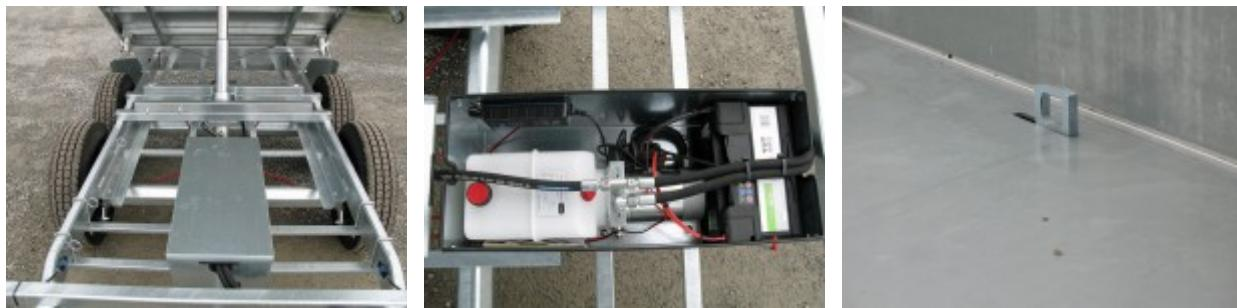
**Hydraulik:** E Hydraulik mit Batterie und Ladegerät, Notpumpe Pumpless für Akkuschrauber Klappbarer Kennzeichenhalter für Verstauen der Auffahrtschienen unter der Lagefläch Vorbereitung für Auffahrtschienenhalterung
