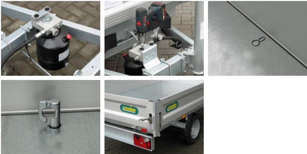
Hydraulikaggregat Pumpless, Kippen mit Akkuschrauber (Akkuschrauber nicht enthalten)
