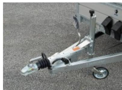
Der Azure L1 ist ein äußerst solider einachsiger Tieflader mit einem komplett geschweißten und vollbadverzinkten Fahrgestell. Ladebodenhöhe 54 cm
