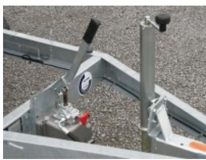
Ein-Achser Rückwärtsskipper mit Hydraulikzylinder und Handpumpe
