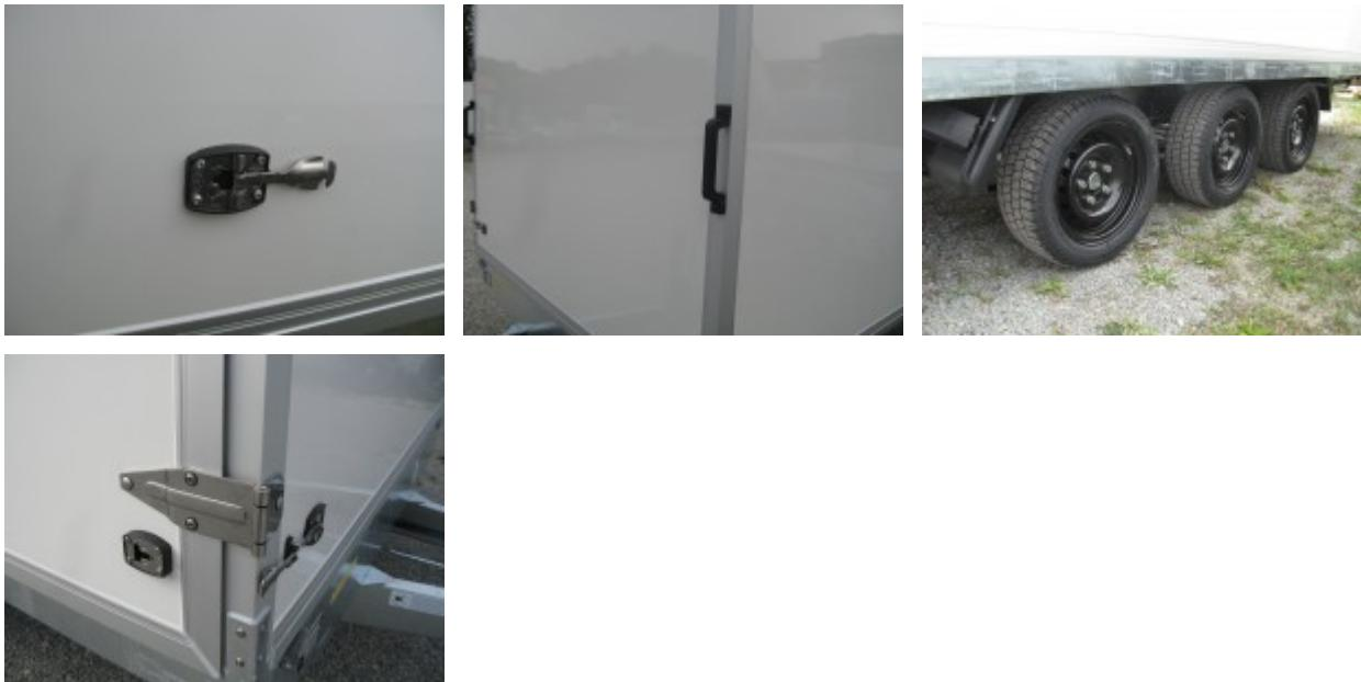
ACHSEN 1800 KG 3 achsig Parabelfederung inklusive Achsstoßdämpfern
