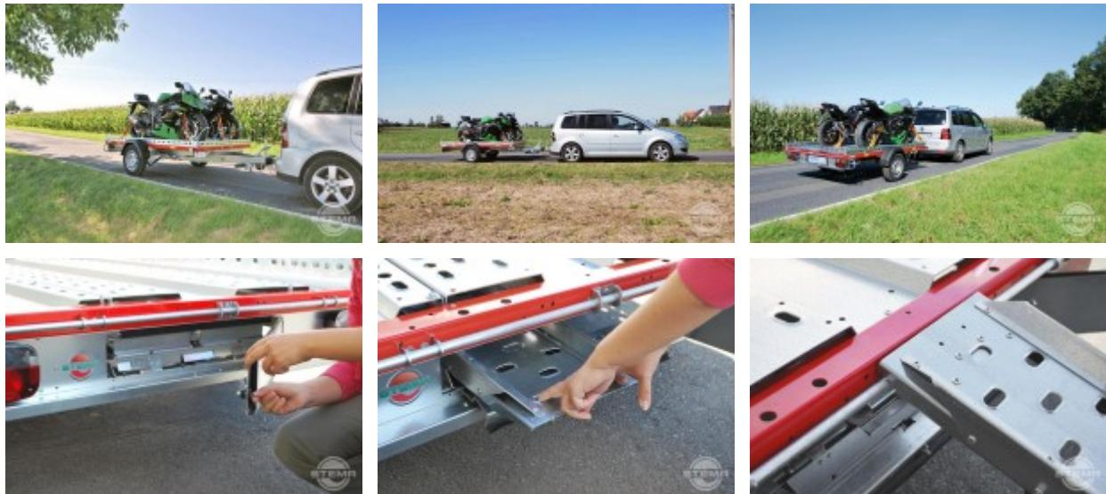
Sie stehen für Sicherheit und Langlebigkeit, sind bequem zu Be- und Entladen und verfügen über eine perfekte Straßenlage. Die neue MT SySTEMA Serie ist darüber hinaus auch für anderes Transportgut geeignet. Mit wenigen Handgriffen sind Bordwände und Hochplane aufgesteckt. So schützen Sie Ihr Motorrad bei langen Fahrten oder meistern anderweitige Transporte.
