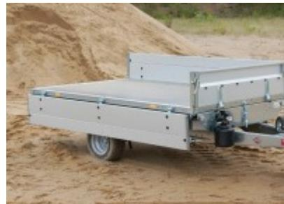
Die kompakten Rückwärtsskipper von STEMA sind für den anspruchsvollen, gewerblichen Einsatz gemacht. Die massive Stahlprofilbrücke, doppelwandige Bordwände, die praktische Pendelbordwand und die mit verzinkter Stahlblechauflage verstärkte Siebdruckbodenplatte meistern echte Belastungen.
