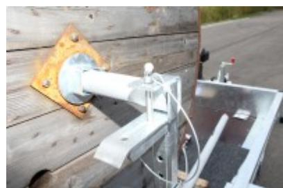
Halterung für Kabeltrommel, mit Ratsche, ca. 600-1000 mm höhenverstellbar, Belastung max 1500kg, Windenbock 900kg Handseilwinde, inkl. Schraubbaren Bodenverstärkung Gewicht 155kg reduziert die Nutzlast- Neuheit mit Rampen seitlich wegklappbar zur Beladung mit Stapler **Rahmen**:
