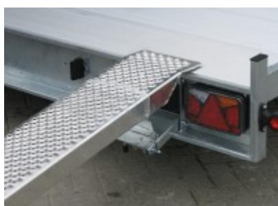
Multi Load 3 achsig , Parabelfedern für sehr gute Fahreigenschaften niedrige Ladehöhe 550 mm durch 10 Zoll Fahrwerk Aluminiumprofilboden Auffahrrampen im Bohlenschacht 2500mm Lang Max 4000kg Tragkraft Seilwinde mit Windenbock
