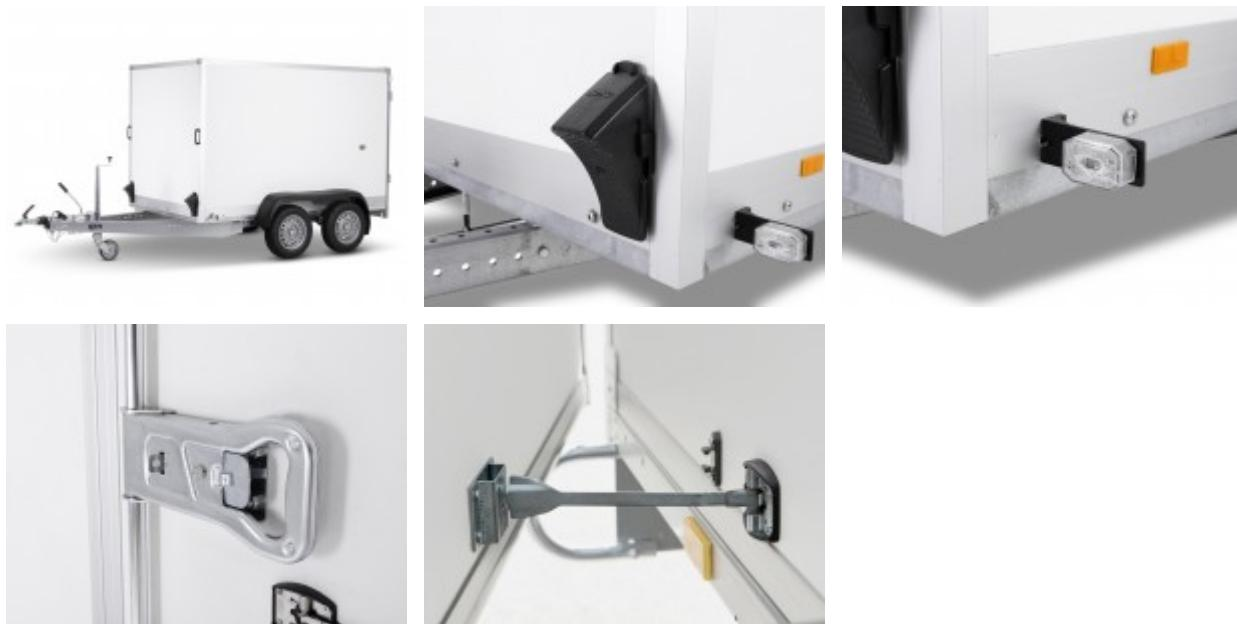
Ein Tieflader mit sehr guter Straßenlage und sicherer Ladung. Die SySTEMA Box basiert auf dem stabilen Grundrahmen mit der STEMA Sicherheits-V-Deichsel. Die robuste Gummifederachse mit Einzelradaufhängung gibt dem Anhänger sehr gute Nachlaufeigenschaften und eine perfekte Straßenlage.
