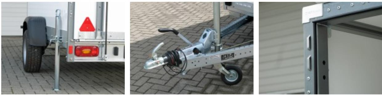
Ein Tieflader mit sehr guter Straßenlage und sicherer Ladung. Die SySTEMA Box basiert auf dem stabilen Grundrahmen mit der STEMA Sicherheits-V-Deichsel. Die robuste Gummifederachse mit Einzelradaufhängung gibt dem Anhänger sehr gute Nachlaufeigenschaften und eine perfekte Straßenlage.
