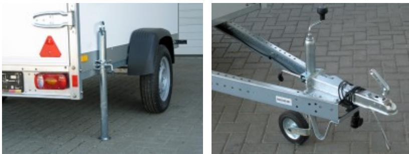
Ein Tieflader mit sehr guter Straßenlage und sicherer Ladung. Die SySTEMA Box basiert auf dem stabilen Grundrahmen mit der STEMA Sicherheits-V-Deichsel. Die robuste Gummifederachse mit Einzelradaufhängung gibt dem Anhänger sehr gute Nachlaufeigenschaften und eine perfekte Straßenlage.
