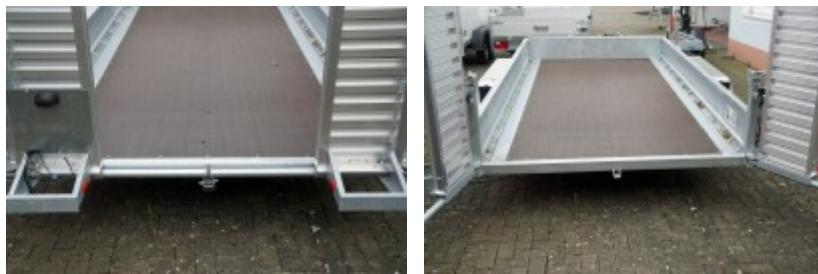
**Neuheit mit Rampen seitlich weggklappbar zur Beladung mit Stapler **Rahmen**:**
