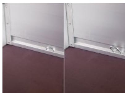
HA-Tieflader der Marke Humbaur sind mit einer einzigartigen Rahmen-/Bordwandkonstruktion aus stabilem und eloxiertem Aluminium aufgebaut.
