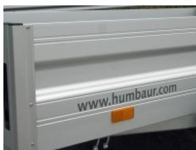
HA-Tieflader der Marke Humbaur sind mit einer einzigartigen Rahmen-/Bordwandkonstruktion aus stabilem und eloxiertem Aluminium aufgebaut.
