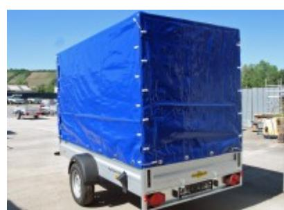
Hochplane 1800 mm Innenhöhe - Farbe wählbar - Hersteller Planencenter Ulm HA-Tieflader der Marke Humbaur sind mit einer einzigartigen Rahmen-/Bordwandkonstruktion aus stabilem und eloxiertem Aluminium aufgebaut.
